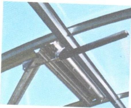
Система автоматической вентиляции поддерживает заданную температуру воздуха в теплице открыванием вентиляционных форточек. Поддержание температуры происходит без участия человека и спасает тепличные растения от суточных перепадов температур и других природных воздействий.
