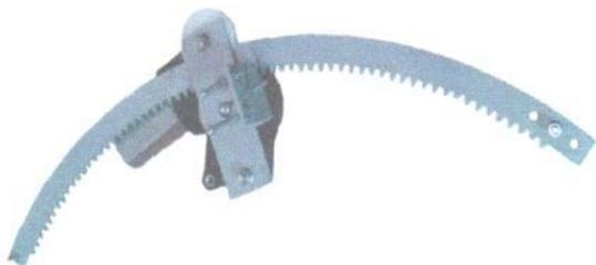
Электрический привод автоматического форточек по команде контроллера проветривания теплицы на право наружу - смотрим со стороны крепления привода (изнутри теплицы). Для правильного выбора -слева есть изображение схемы открытия двери. Нажмите для увеличения. Напряжение питания DC 12в. мощность 60 ватт. Вес 1,8 кг. Угол открытия 140 градусов.
