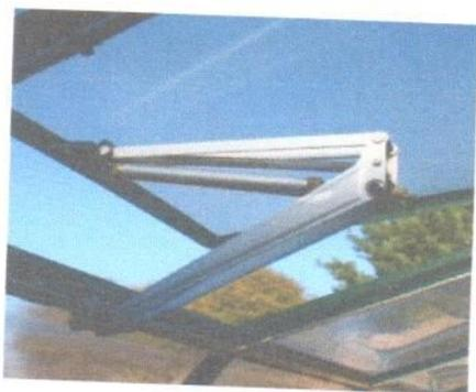
Автоматический аппарат для проветривания представляет собой гидравлическое устройство открытия форточки теплицы с возможностью регулировки рабочих температур. Это незаменимое устройство для создания благоприятной среды в теплице botanik для Ваших растений и рассады 24 часа в сутки.
